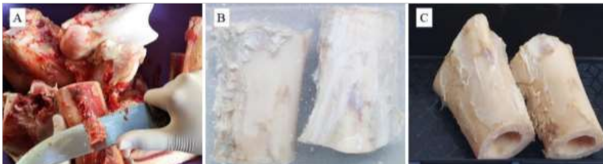
Figura 4 - Preparação dos resíduos ósseos para calcinação. (A) Remoção manual de parte da matéria orgânica. (B) – Imersão em solução de hipoclorito de sódio e água. (C) – Material pronto para pesagem e calcinação. Fonte: Elaborado pela autora (2023).
