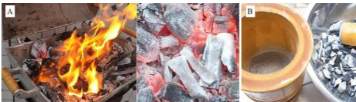
Figura 5 - Etapas do processo de calcinação do material ósseo. (A) Calcinação em churrasqueira, com destaque na coloração dos ossos ao longo do processo. (B) Trituração do calcinado em pilão de madeira. Fonte: Elaborado pela autora (2023).
