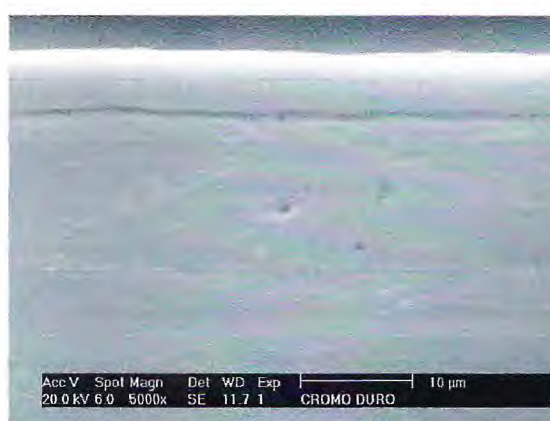
Figura 4.21. Micrografia da seção transversal do revestimento de cromo obtida por microscopia eletrônica de varredura.
