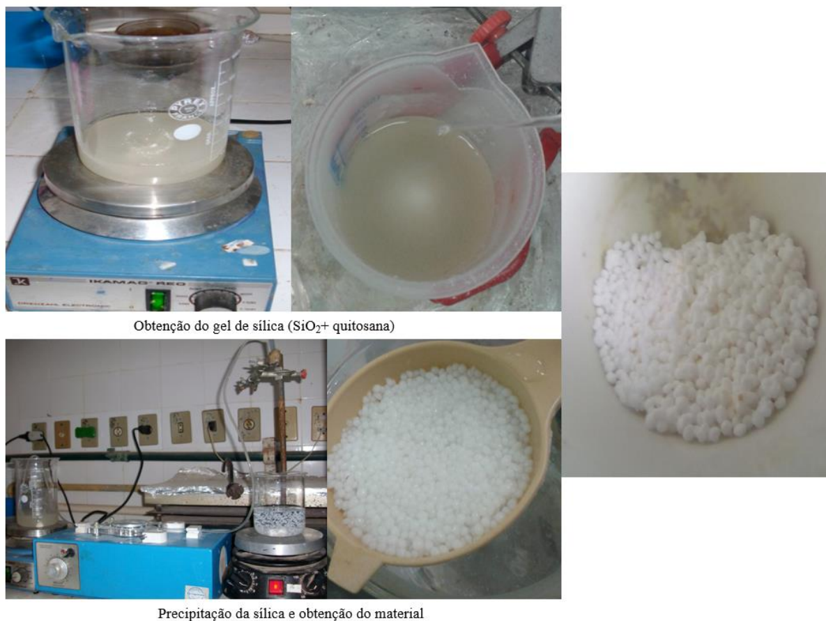
Figura 22. Fotografias das soluções e dos materiais obtidos durante as etapas de preparação das microesferas de sílica- mPSi
