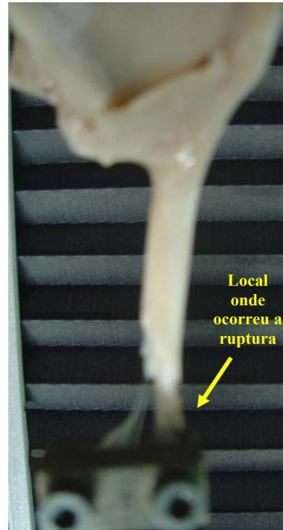
**Figura 17** – Detalhe do local de ruptura no experimento na Máquina INSTRON 4443. Local da ruptura.
