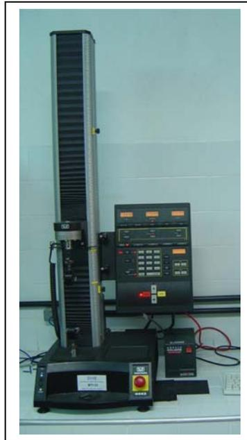
FIGURA 10 - Máquina de tração Dinâmica INSTRON 4443.
