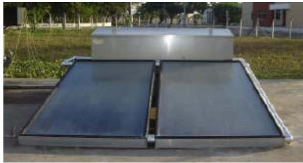
Figura1 – Fotografia do dessalinizador solar com coletores planos e torre horizontal.
