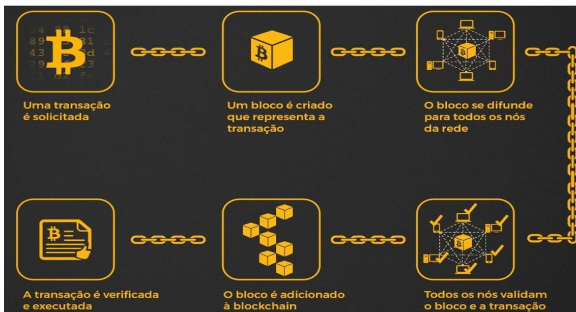
Figura 2: Processo simplificado de transação e validação no blockchain .
