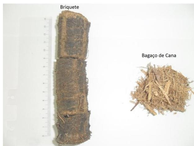
**Figura 1. Bagaço da cana de açúcar e briquete produzido.**
