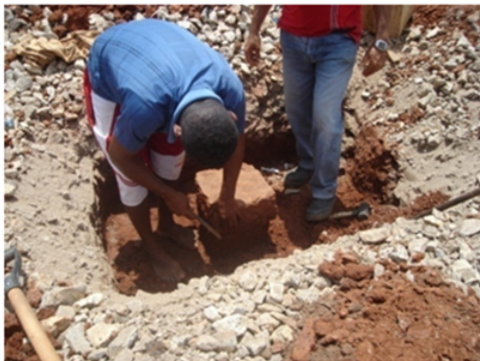
Figura 3: Extração dos blocos indeformados.
