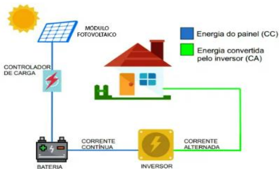
Figura 8 – Esquema básico de um sistema de geração Off Grid.
