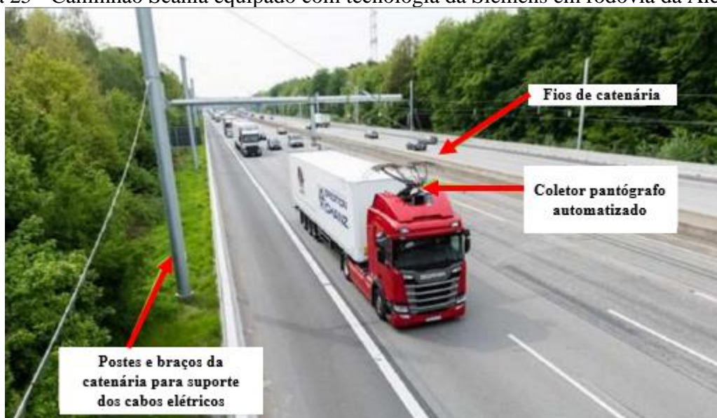
Figura 25 - Caminhão Scania equipado com tecnologia da Siemens em rodovia da Alemanha
