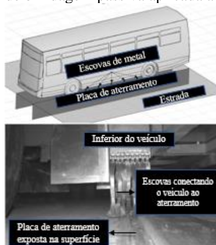
Figura 22 - Ilustração de blindagem passiva aplicada ao ônibus OLEV
