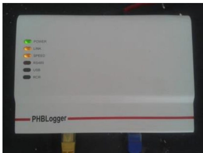
Figura 22 - Datalogger PHB Solar de PFV1.
