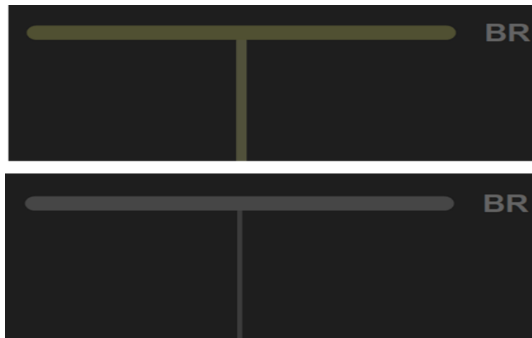
Figura 32 - XControl de barras e linhas energizadas (acima) e não energizadas (abaixo).
