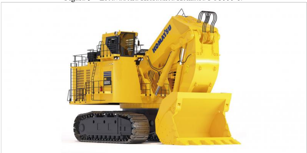
Figura 5 – Escavadeira Hidráulica Komatsu PC8000-6.
