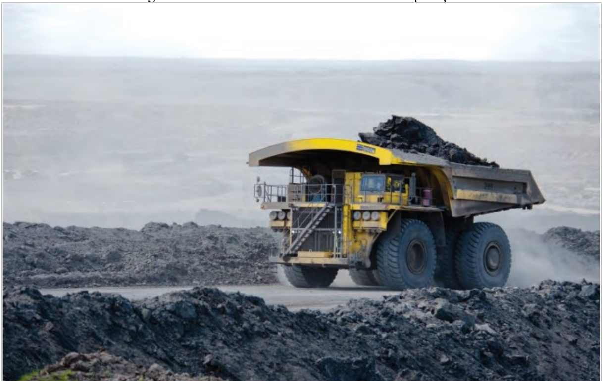
Figura 10 – Caminhão Komatsu 960E em Operação.
