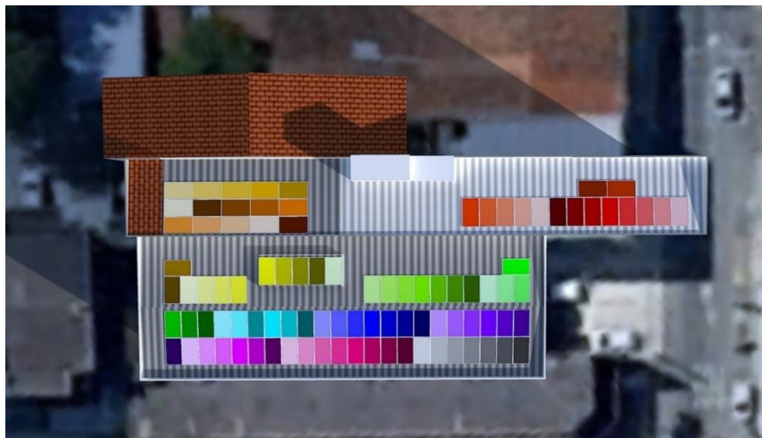
Figura 22 - Distribuição dos módulos FV por MPPT dos microinversores.
