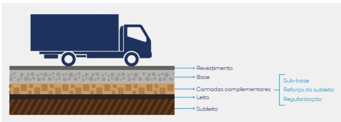
**Figura 2- Disposição das camadas de pavimento tipo flexível. Fonte: CNT (2021).**
