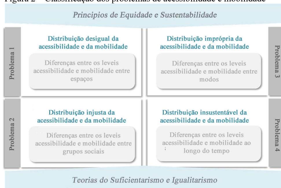
Figura 2 – Classificação dos problemas de acessibilidade e mobilidade
