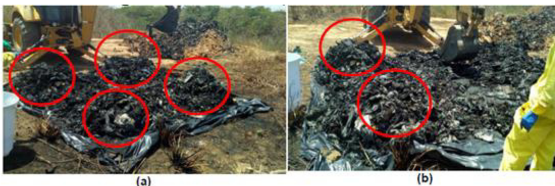
Figura 11 - Quarteamento final (a) e separação em duas partes para seleção de análise (b)
