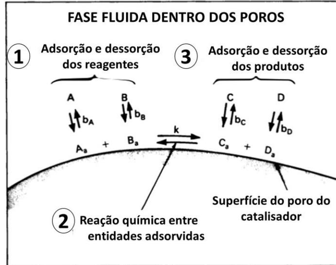
(1) adsorção dos reagentes, (2) reação química entre as entidades adsorvidas, (3) adsorção e dessorção dos produtos.
