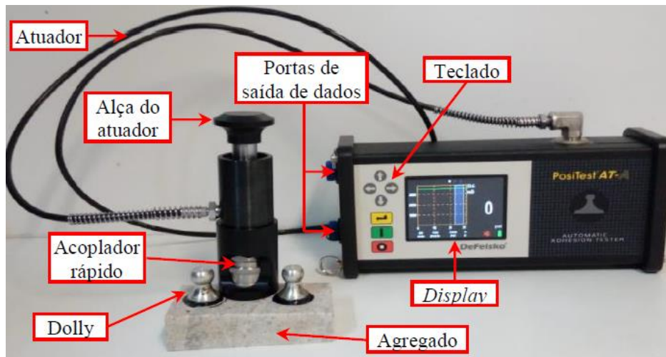
Figura 44 - Equipamento usado em ensaio de arrancamento BBS
