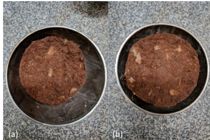
Figura 14 – Corpos de prova dos ensaios de compactação: (a) Solo + 0,5% de fibras; (b) solo + 1,0% de fibras.
