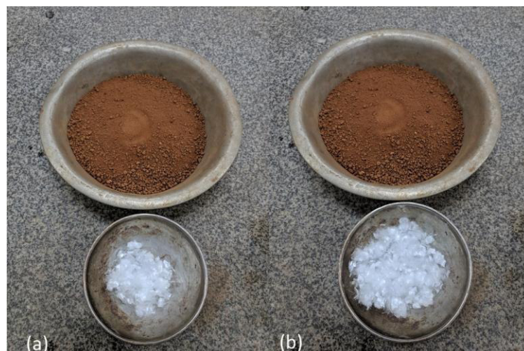
Figura 10 – Amostras: (a) Solo e 0,5% de fibras; (b) Solo e 1,0% de fibras.
