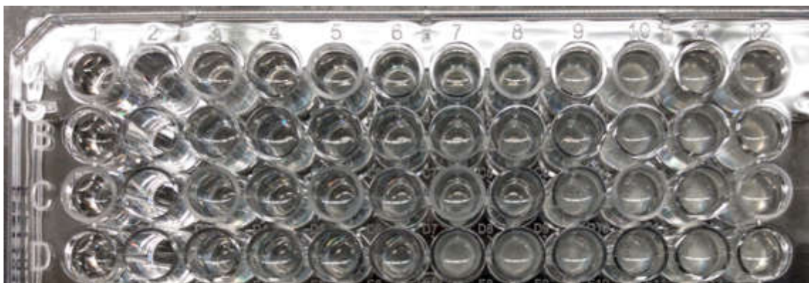
Figura 36 - Poços de microplacas com concentrações crescentes de CNCs da esquerda para a direita. Em concentrações mais altas de CNCs, um padrão de esporulação para B. subtilis é observado.
