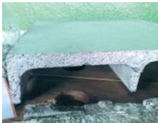
Figura 10: Bloco de concreto adicionado de Borracha de pneus inservíveis
