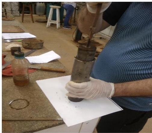
(a) Moldagem do corpo de prova
