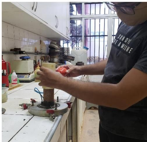
(b) Montagem da amostra na célula triaxial
