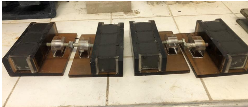
Figura 5 - Fôrma em acrílico com a argamassa moldada
