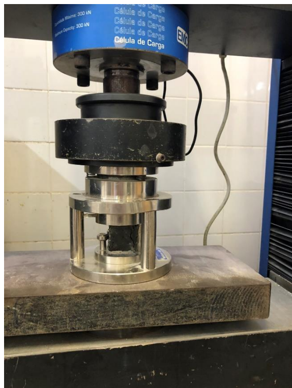
Figura 6 - Ensaio de resistência à compressão
