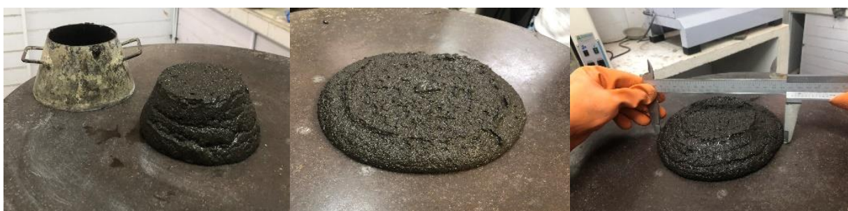
Figura 4 - Ensaio mesa de consistência
