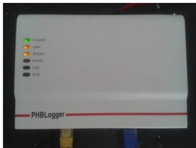
Figura 22 - Datalogger PHB Solar de PFV1.
