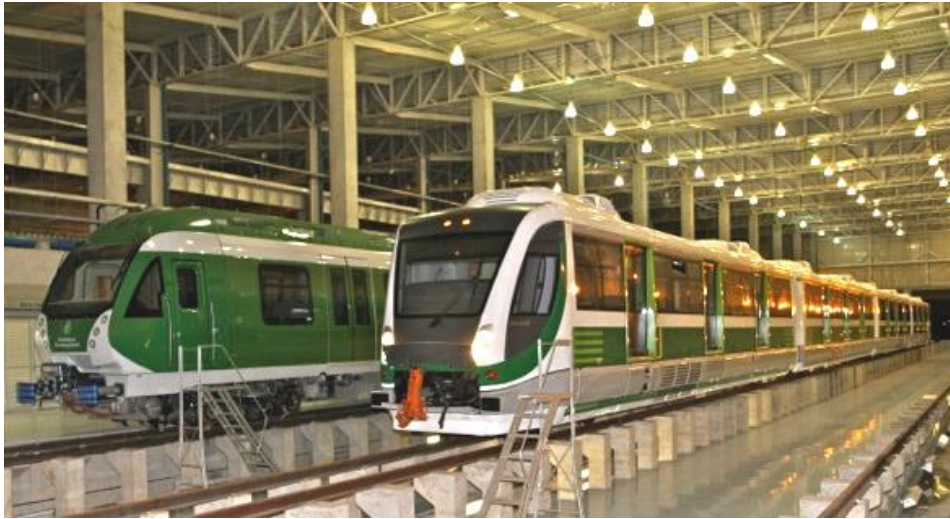
Figura 17 - Um TUE (esquerda) e um VLT (direita) no Centro de Manutenção do METROFOR
