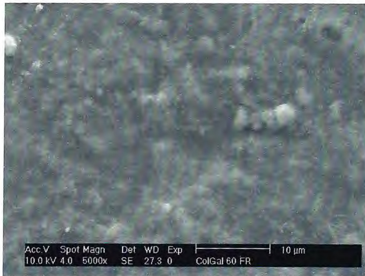
Figura 58 – Micrografias de filme de GalCol (3:2) reticulado com GA 0,1%, e com adição de frutalina. Ampliada 5000x.
