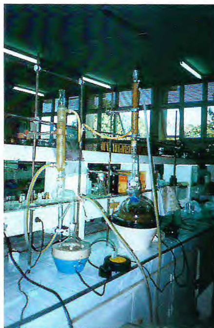
Sistemas de extração de óleos essenciais. Fotógrafo: Nilce V. Gramosa (Agosto de 1998).
