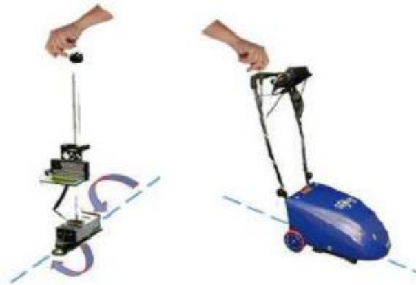
Figura 3 - Equipamentos de classe I, Dipstick (esquerda) e Walking Profiler (direita)
