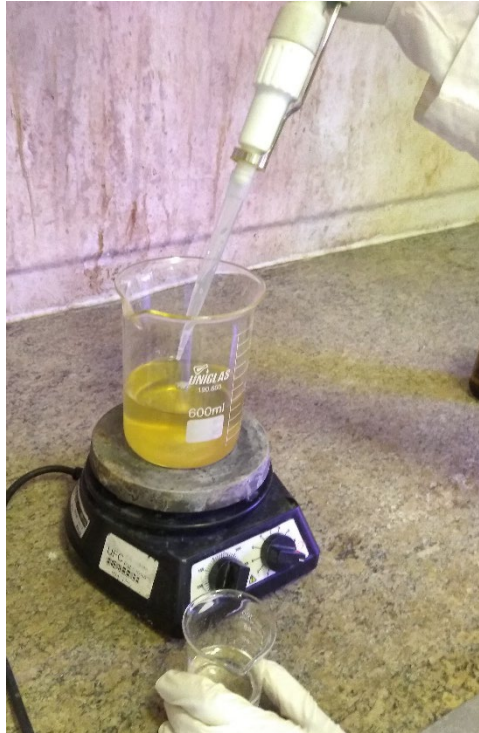
Figura 1. Adição da glicerina a solução de quitosana em agitação
