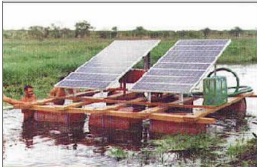
Figura 9. Sistema fotovoltaico flutuante de bombeamento de água.
