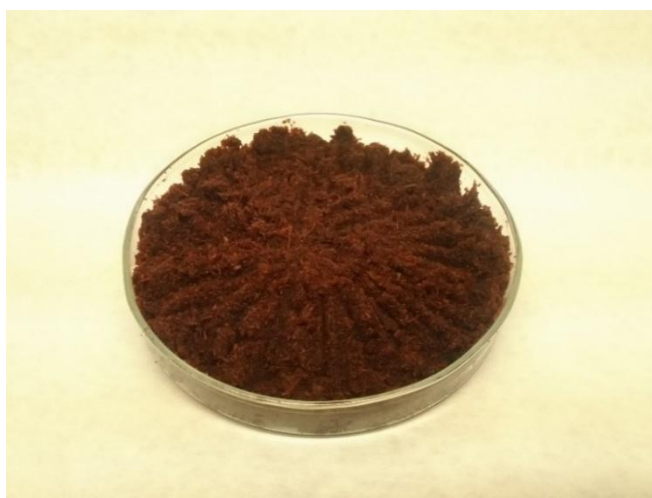
Figura 13 – Aspecto visual do resíduo de extração de R-FE de Solieria filiformis por homogeneização
