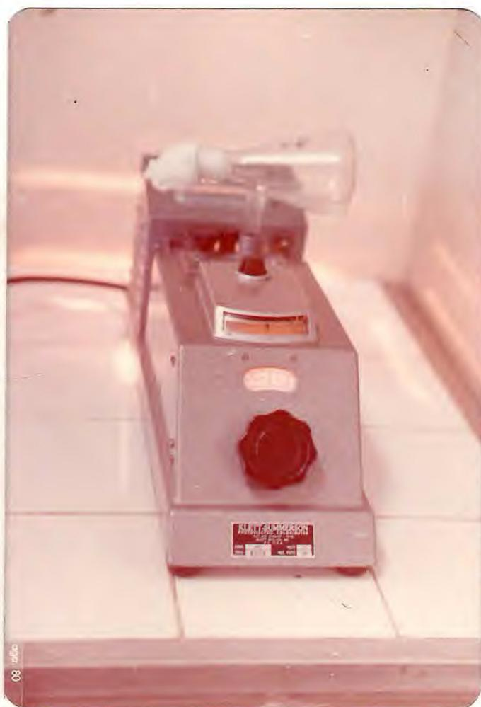
FIGURA 7 - Colorímetro fotoelétrico Klett-Summerson com erlenmeyer dotado de braço lateral, utilizado para acompanhar o aumento de turbidez de suspensões celulares em crescimento.
