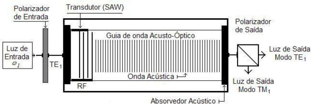
Figura 2.3: Esquema de um Filtro Acusto-Óptico Sintonizável (AOTF) dependente da polarização da luz de entrada [19].
