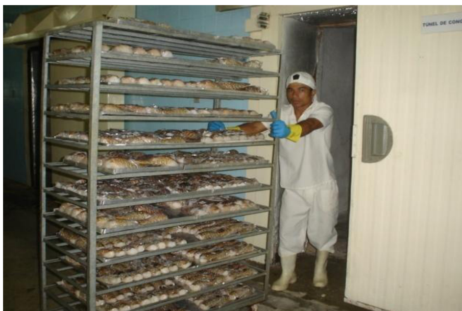
Figura 24 – Caudas de lagostas sendo transportadas no carro porta-bandejas até o túnel de congelamento da INTERFRIOS.
