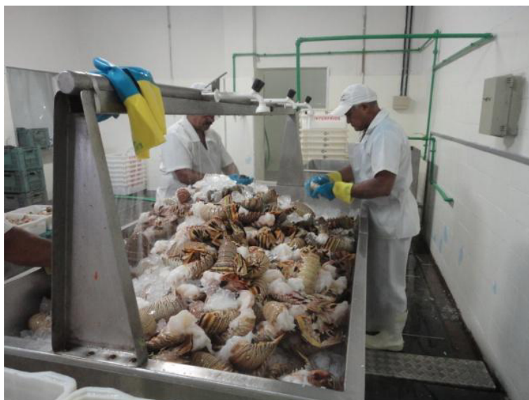
Figura 2 – Mesa de aço inox com chuveiros verticais, utilizados no recebimento das caudas de lagosta, na INTERFRIOS.
