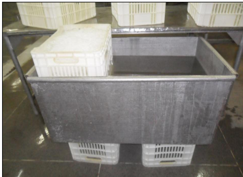
Figura 20 – Tanque com solução de tripolifosfato de sódio e gelo na INTERFRIOS – Intercâmbio de Frios S.A., em Fortaleza, Ceará.
