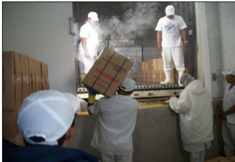
Figura 24 – Transporte do produto em caminhões colocados na antecâmara para manter a cadeia do frio durante sua expedição na INTERFRIOS – Intercâmbio de Frios S.A., em Fortaleza, Ceará..
