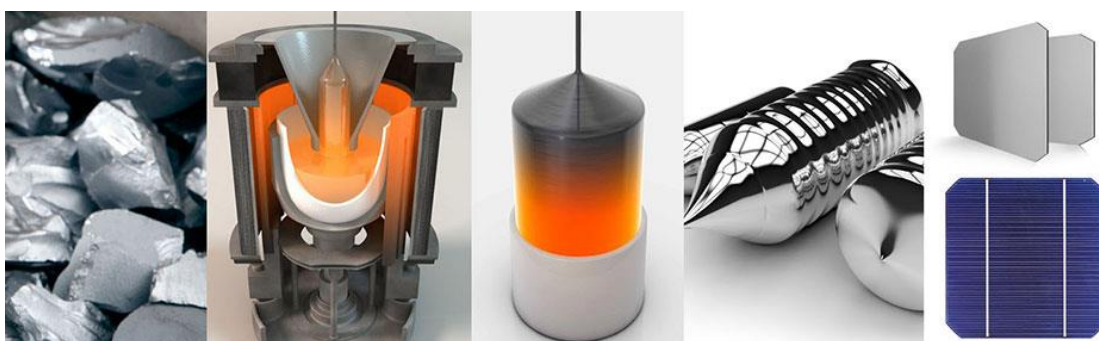
Figura 4 - Processo de fabricação do silício monocristalino
