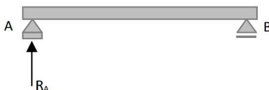
Figura 6: Elemento figurativo de viga com dois apoios.
