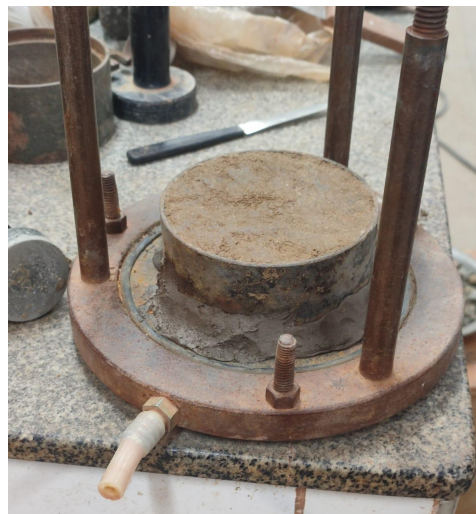
Figura 16 – Moldagem e vedação do corpo de prova no permeâmetro.
