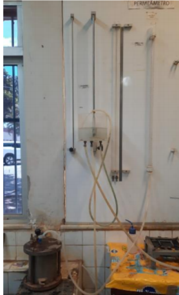
Figura 15 - Permeâmetro à carga variável da UFC – Campus Pici.
