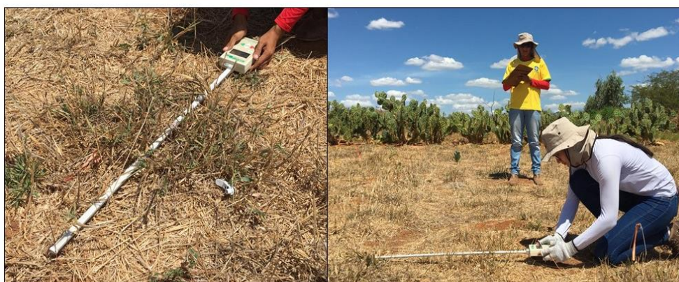
Figura 8 – Utilização do medidor PAR/LAI em Agricultura para determinação da IRFA e IAF durante a época seca
