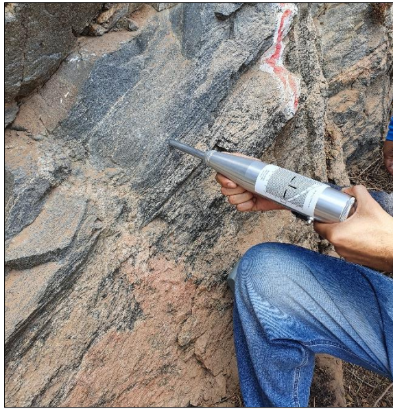
Figura 42 - Procedimento empregado para medição do rebote com emprego do Martelo de Schmidt
