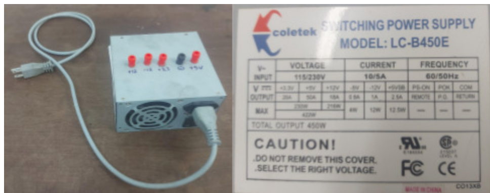
Figura 15 — Fonte ATX usada nos experimentos e suas especificações.
