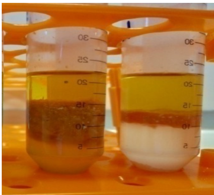
Figura 3: Sistema de Quechers utilizado para extração de resíduos de agrotóxicos em amostra de alimento.
