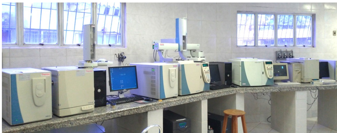
Figura 5: Cromatógrafos Gasosos acoplados à espectrometria de massas utilizados para determinação de agrotóxicos em água e alimentos após aplicação das técnicas de extrações.
