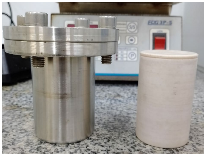
Figura 8. Autoclave de aço e reator de teflon.
