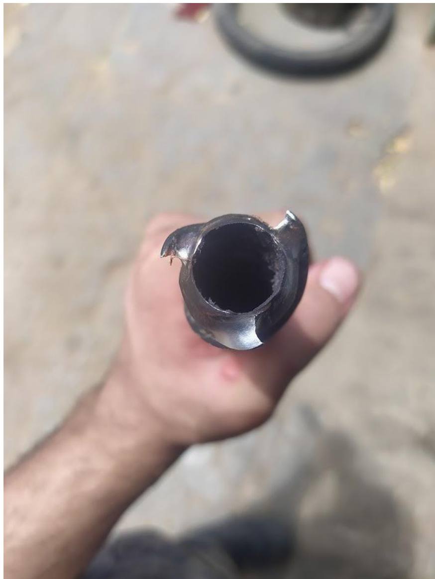
Vista frontal da broca oca de aço utilizada junto a um motor de dois tempos movido a gasolina para extrair amostras dendrocronológicas não-destrutivas
