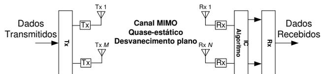
Fig. 3. Esquema MIMO genérico.
