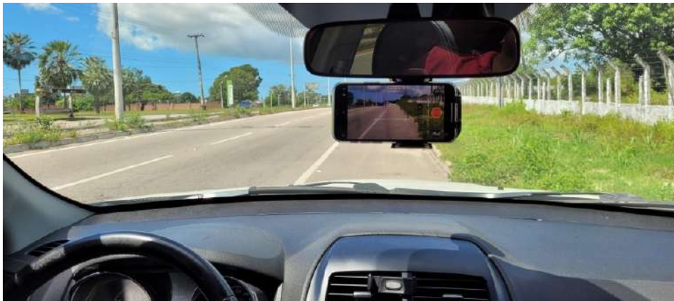
Figura 21 – Processo de aquisição de dados pelo iPhone
