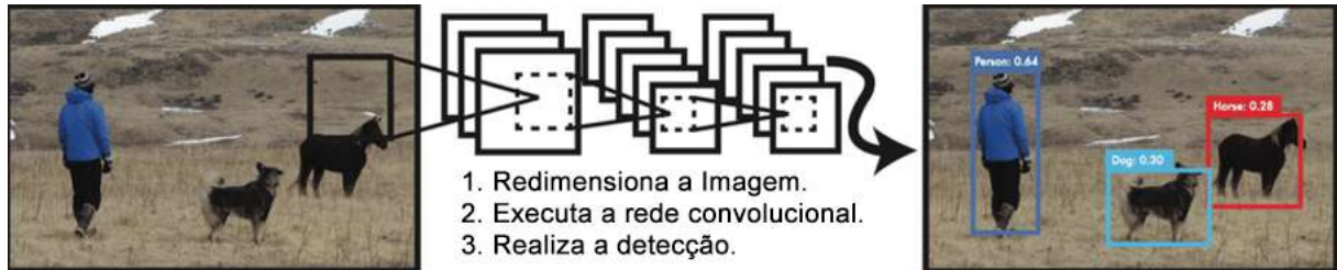
Figura 18 – Sistema de Detecção do YOLO
