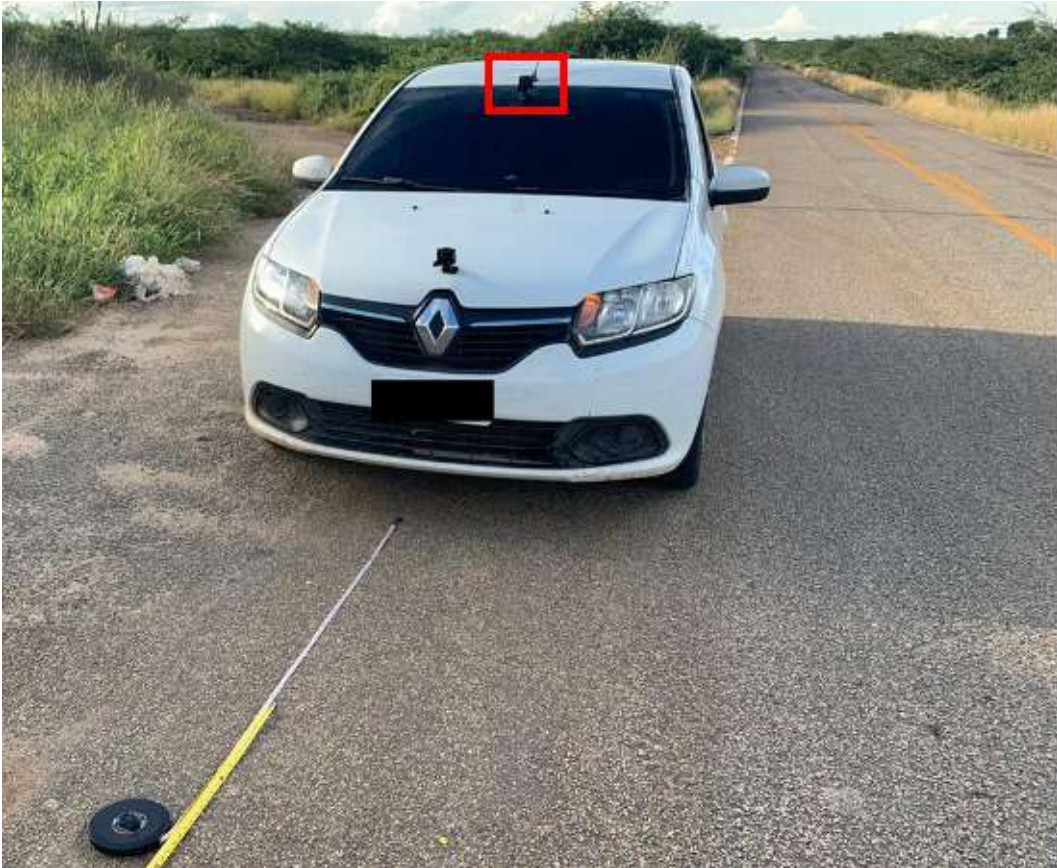
Figura 25 – Processo de aquisição de dados pela GARMIN 4K
