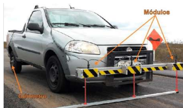
Figura 9 – Perfilômetro a laser acoplado no veículo
