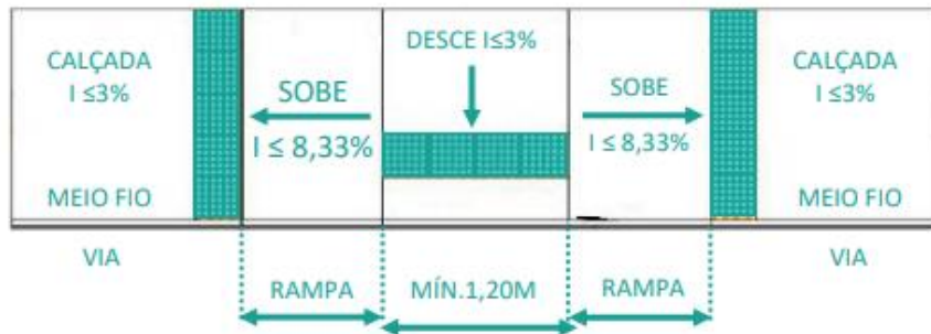
Figuras 9 e 10 – Alinhamento do imóvel – Vista superior – Rebaixamento em calçadas estreitas
