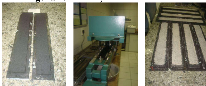
Figura 5: Realização do ensaio LWT e adesão de areia
