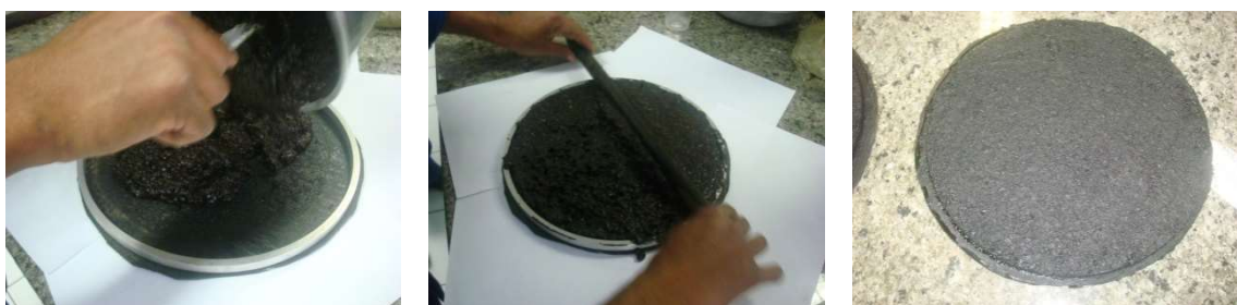
Figura 1: Moldagem dos corpos-de-prova para ensaio WTAT
