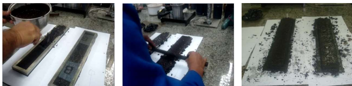
Figura 2: Moldagem dos corpos-de-prova para ensaio LWT
