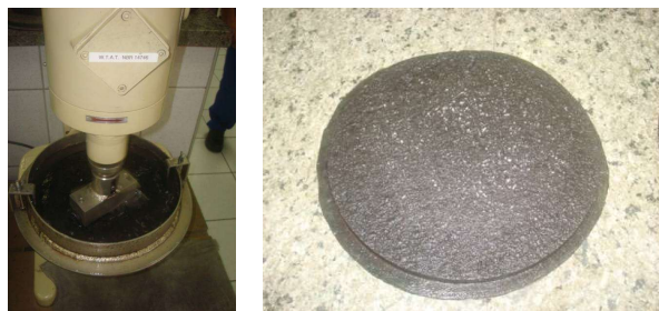
Figura 4: Realização do ensaio WTAT
