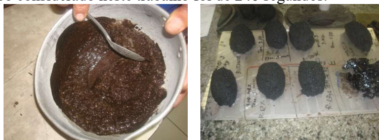
Figura 6: Realização do ensaio de determinação do tempo mínimo de misturação
