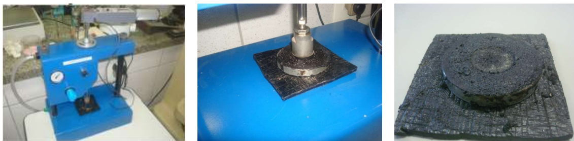
Figura 7: Realização do ensaio de coesão
