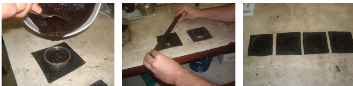
Figura 3: Moldagem dos corpos-de-prova para ensaio de coesão
