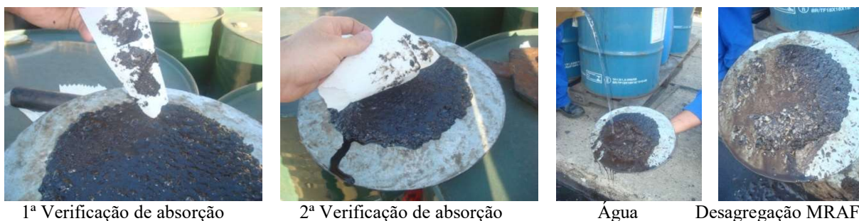
Figura 13: Realização da metodologia com um ligante inadequado
