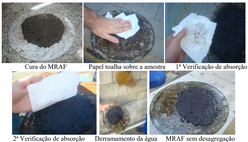
Figura 12: Realização da metodologia com um ligante adequado
