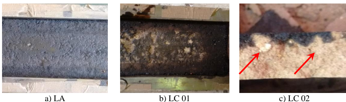
Figura 6: Aspecto das placas após o ensaio LWT à taxa de 0,8 \text{ L/m}^2 na W_{ót-2}
